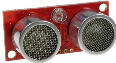
Abbildung 2: Ultraschallsensor SRF08
